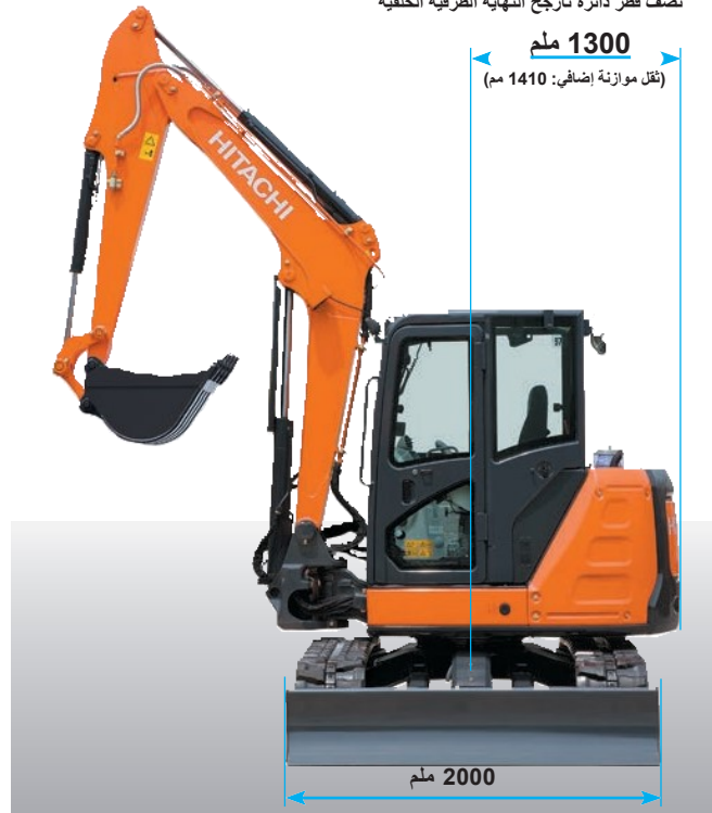
نماذج المعدات المعروضة مزودة بذراع طوله 1.85 م وأذليلب إضافية ومصفى أولي
