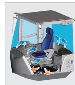
温度設定によって、風量や吹き出し口、温度を自動的にコントロール。さらに、足元を暖かく、顔部分を冷やすといったように、場所によって温度を変えられるバイレベル機能を搭載。また、キャブ内の気圧を外部よりわずかに高めた加圧キャブは転圧現場などで発生する非常に細かい粉じんの侵入を防ぎ、キャブ内を清潔に保ちます。ほこりの多い現場向けに、エアコン外気ダブルフィルタをオプションで用意しています。
