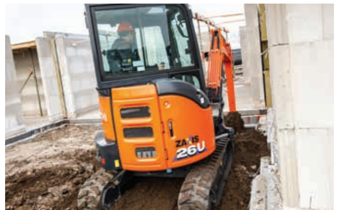
Der kleine Heckschwenkradius ist ideal für Arbeiten unter beengten Platzverhältnissen.
