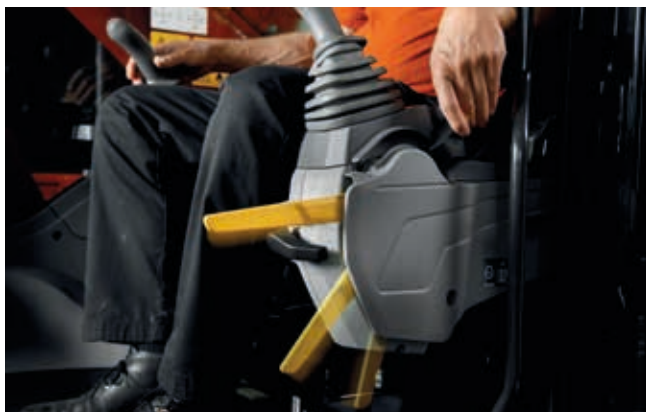
Der Vorsteuerabsperrhebel bietet größere Sicherheit in der Kabine.
