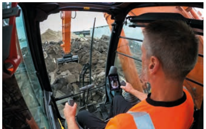
La conception de l'essuie-glace à vue étendue offre une plus grande visibilité.
