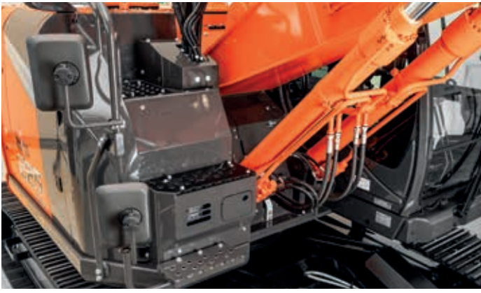
Les larges marches du ZX225US/USR-7 permettent de faciliter l'entretien.
