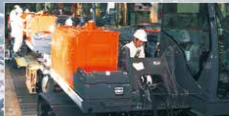
Ligne d'assemblage des pelles de taille intermédiaire
