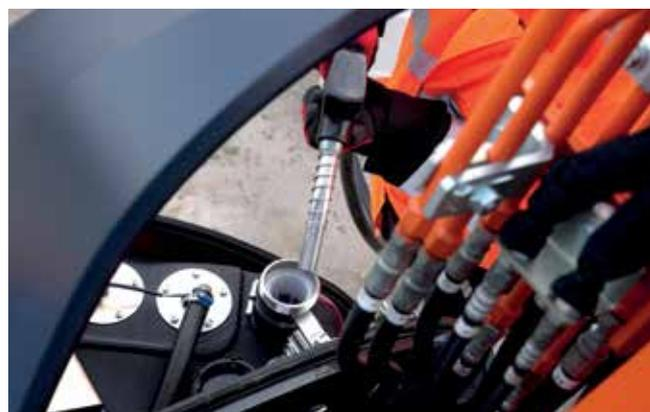
Le réservoir de carburant a également été repositionné pour faciliter et sécuriser le remplissage.
