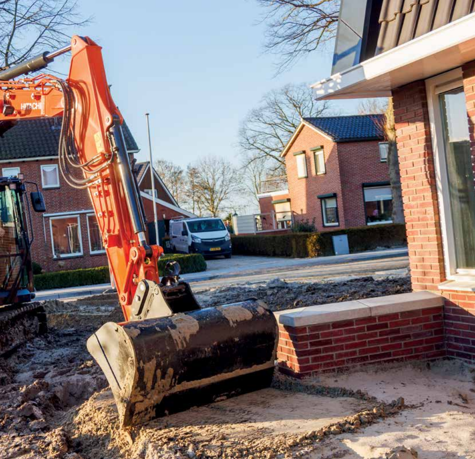
La breve distanza tra benna e lama aumenta l'efficienza e la sicurezza.
