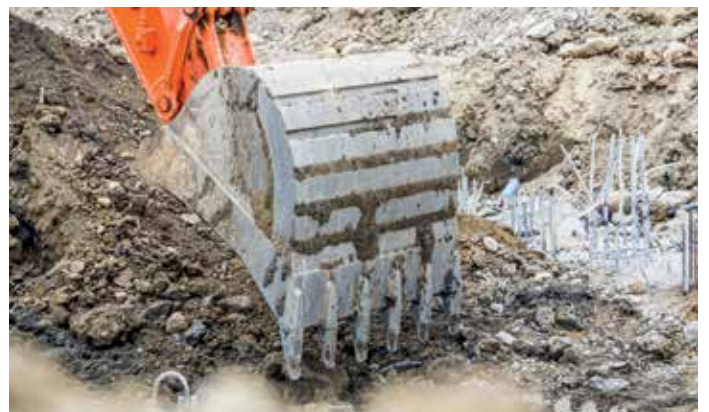
I GET di Hitachi comprendono denti autoaffilanti e adattatori affidabili, per garantire un montaggio preciso.
