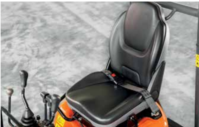
Verschiebbarer Sitz mit neu platziertem Sicherheitsgurt, neue Griffe für die Motorhaube und Neigungsanschlag.
