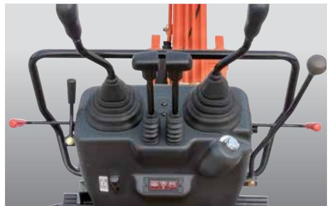
Leicht zugänglicher Zündschalter und sehr gut sichtbare Kontrollleuchten.
