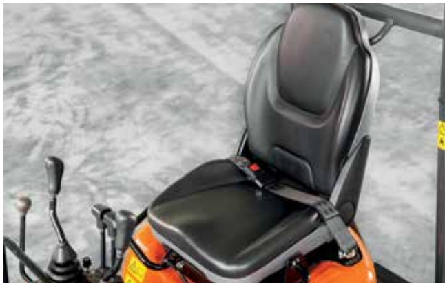
Sedile scorrevole con cintura di sicurezza riposizionata, maniglie del cofano motore e fermo di inclinazione.
