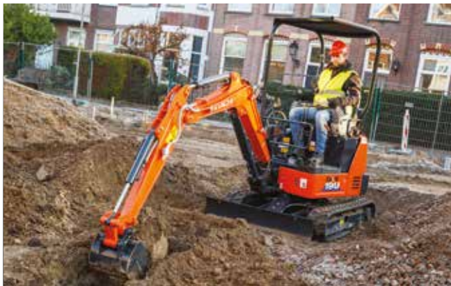
I cingoli estensibili aumentano la versatilità e la stabilità.
