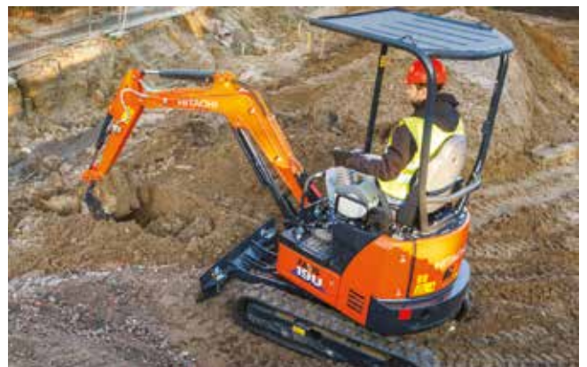
Il tettuccio a tre montanti aumenta la visibilità.
