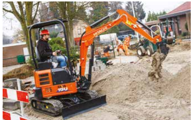
Il ridotto raggio di rotazione è ideale per lavorare in spazi ristretti.
