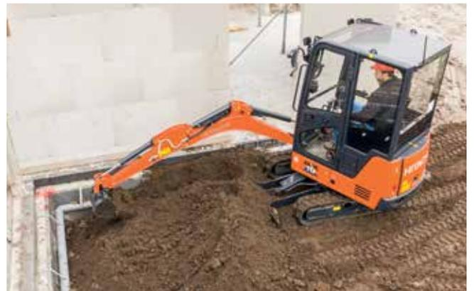
Der minimale Frontschwenkradius ist ideal für Arbeiten unter beengten Platzverhältnissen.
