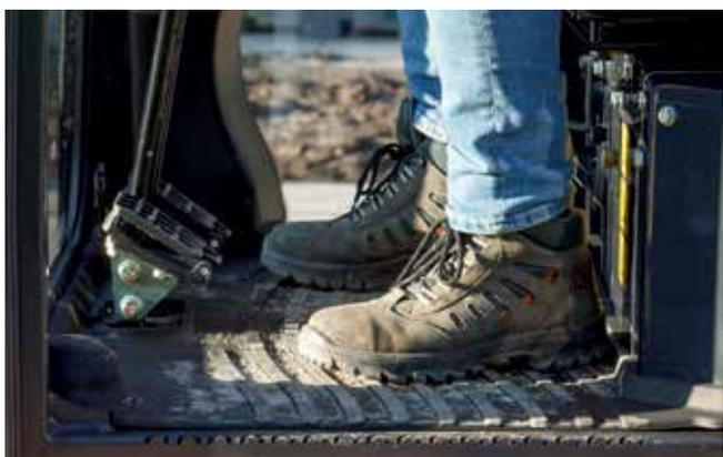
Klappbare Fahrpedale können anstelle eines Handhebels verwendet werden.
