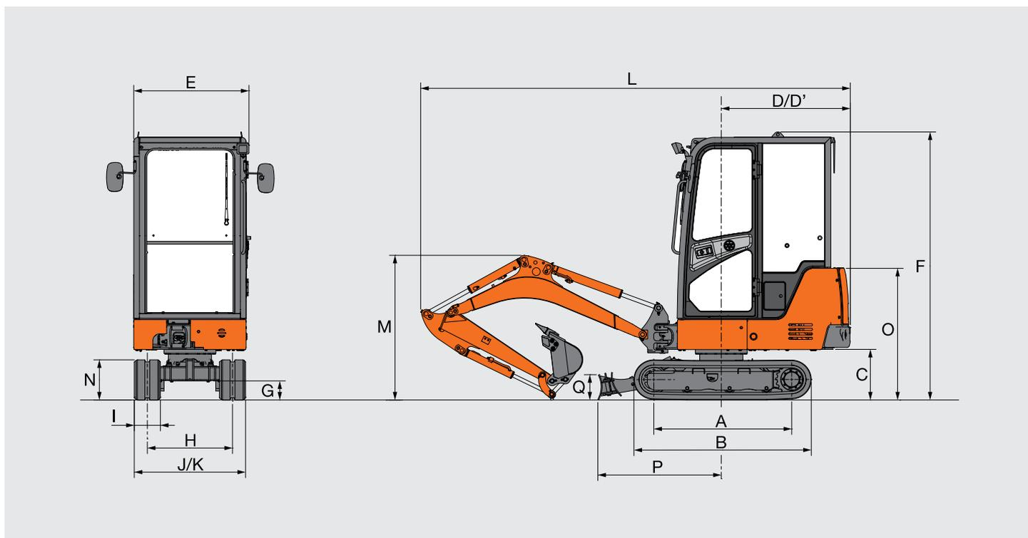
Diese Abbildung zeigt die Maschine mit 1,08 m Stiel, 0,044 m<sup>3</sup>-Löffel und 230 mm Gummiketten.
