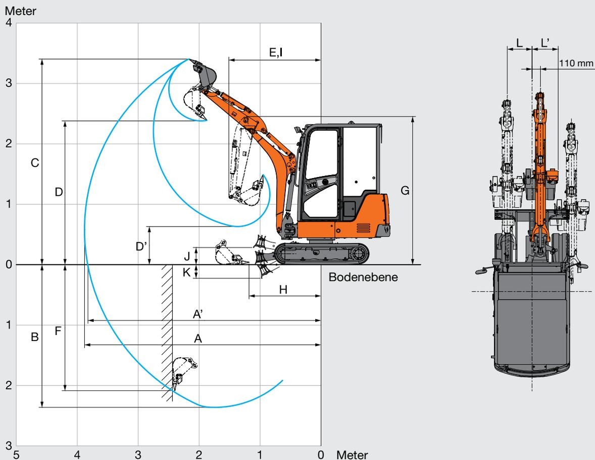
Diese Abbildung zeigt die Maschine mit 1,08 m Stiel, 0,044 m<sup>3</sup>-Löffel und 230 mm Gummiketten.
