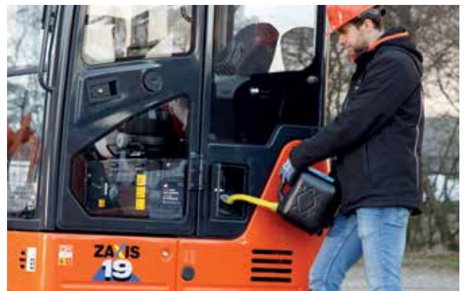
L'apertura del serbatoio del carburante è stata spostata per facilitare il rifornimento.
