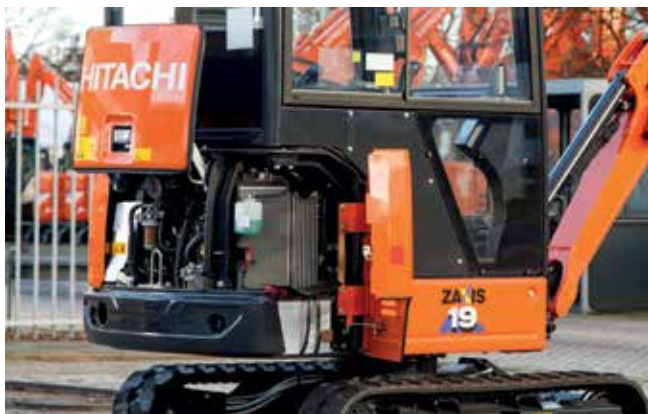
Il coperchio del motore si apre verticalmente, una soluzione ideale negli spazi ristretti.
