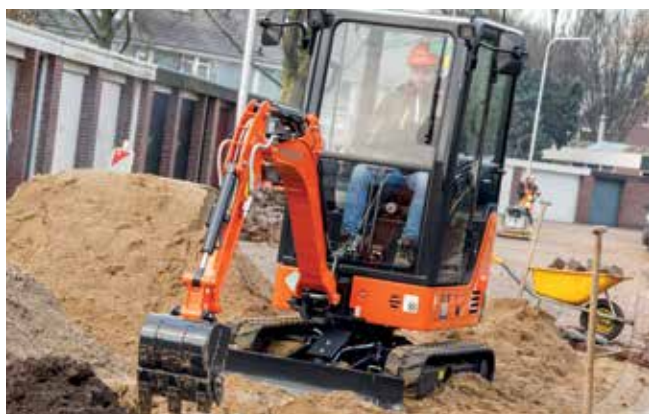
Il tubo flessibile idraulico si trova all'interno del braccio di sollevamento per un'ulteriore protezione.
