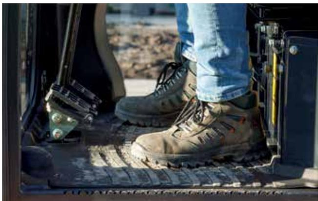
Al posto della leva manuale si possono usare i pedali di traslazione pieghevoli.
