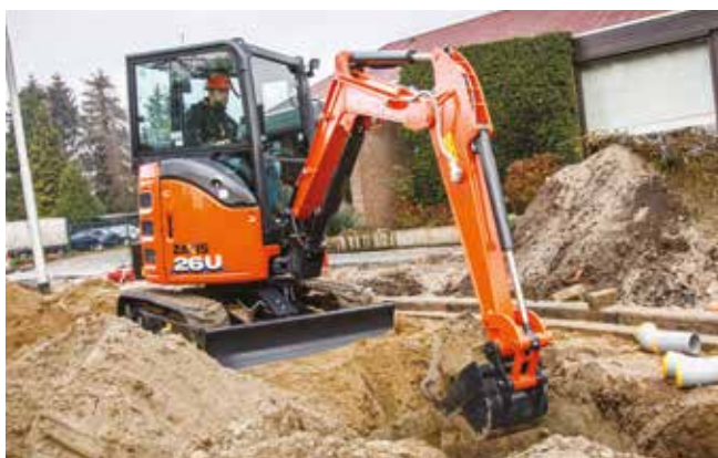
L'avant de la machine est équipé d'une protection du vérin de flèche pour une durabilité accrue.
