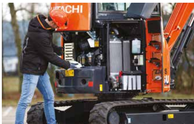
Les capots faciles à ouvrir permettent un accès rapide.
