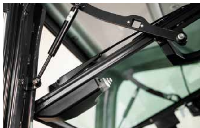
La vitre avant s'ouvre facilement et en douceur grâce à la fonction d'assistance motorisée.
