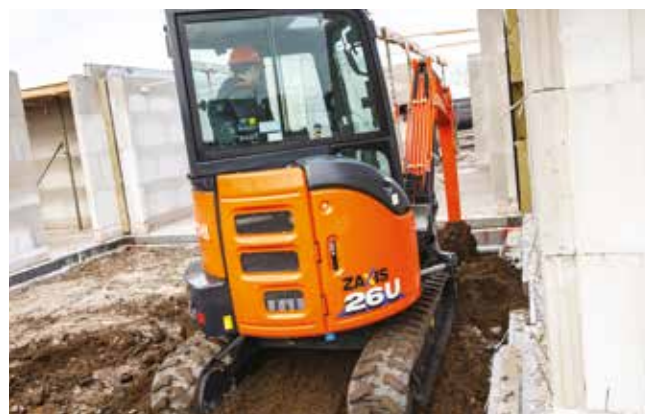
Le rayon de rotation arrière court est idéal pour les travaux dans des espaces exigus.
