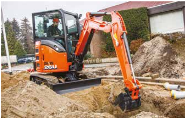
La parte anteriore della macchina è dotata di protezione del cilindro del braccio di sollevamento per maggior robustezza.
