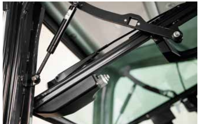
Il finestrino anteriore si apre facilmente e senza scatti grazie all'apertura assistita elettricamente.
