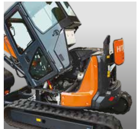
Die kippbare Kabine ermöglicht einen einfachen Zugang zum Motor und zum Steuerventil für eine schnelle Wartung.
