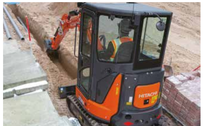
Dank des kleinen Heckschwenkradius ist der ZX33U-6 ideal für Arbeit auf engem Raum.
