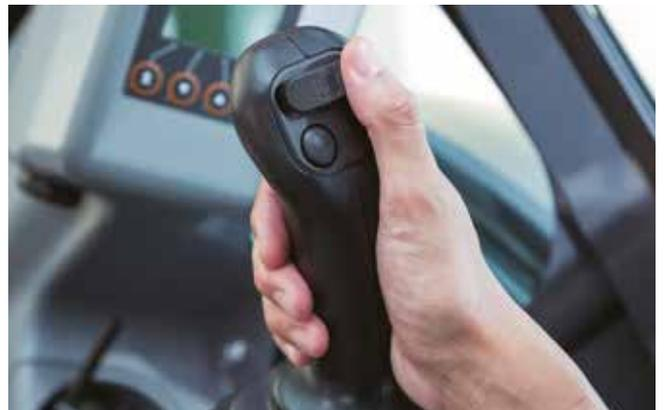
Die Joysticks mit proportionalem Schieberegler gewährleisten eine präzise Steuerung der Anbaugeräte.
