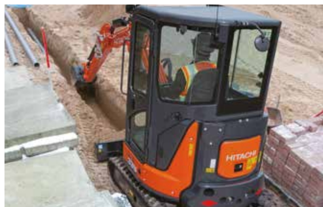
Il raggio di rotazione ridotto dello ZX33U-6 lo rende ideale per lavorare negli spazi ristretti.
