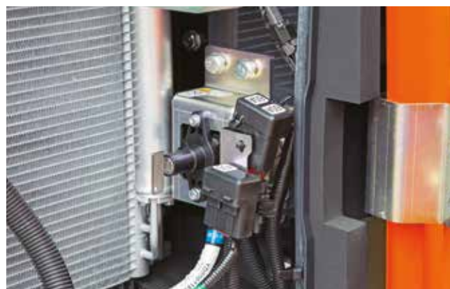
Lo stacca batteria consente di eseguire la manutenzione in condizioni di sicurezza.
