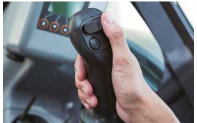
La funzione ausiliaria con comando proporzionale garantisce un controllo accurato.
