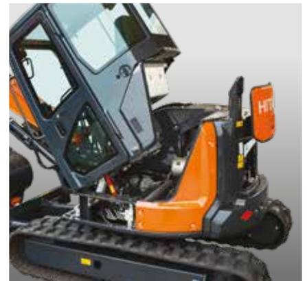
Die kippbare Kabine ermöglicht einen einfachen Zugang zum Motor und zum Steuerventil für eine schnelle Wartung.
