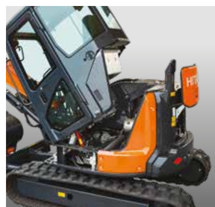
Il pavimento inclinabile consente un facile accesso al motore e alla valvola di controllo, per velocizzare la manutenzione.
