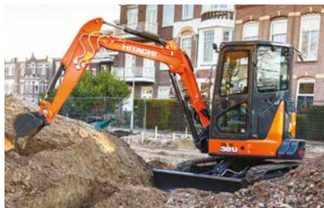
Il ridotto raggio di rotazione del ZX38U-6 lo rende ideale a lavorare negli spazi ristretti.
