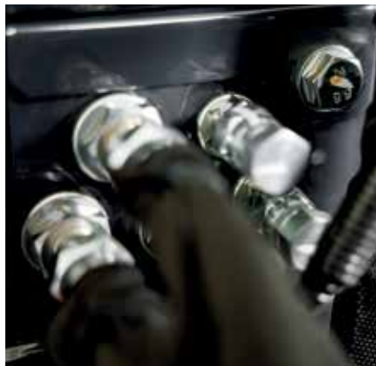
Il collegamento ad attacco rapido (opzionale) posto sotto al vano porta attrezzi, consente l'installazione dei retrofit in condizioni di sicurezza.
