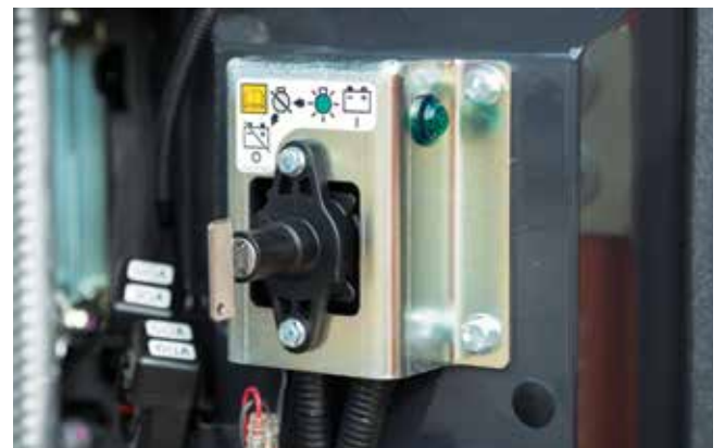
Lo stacca batteria consente di eseguire la manutenzione in condizioni di sicurezza.
