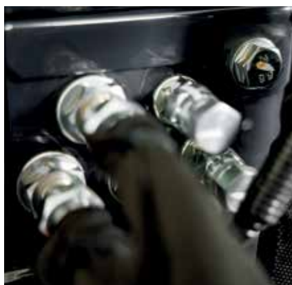
Il collegamento ad attacco rapido (opzionale) posto sotto al vano porta attrezzi, consente l'installazione dei retrofit in condizioni di sicurezza.
