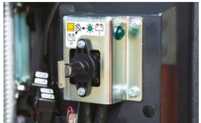
Der Batterie Hauptschalter ermöglicht die sichere Durchführung von Wartungsarbeiten.
