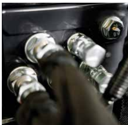
Le raccord rapide (en option) sous la boîte à outils permet une installation ultérieure sécurisée.
