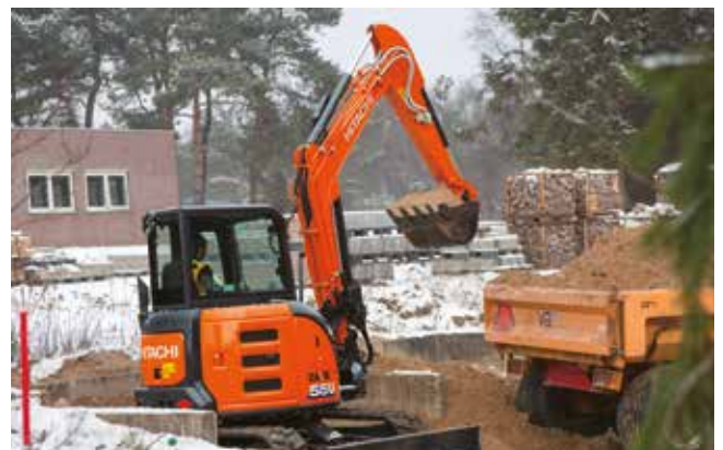
Dank des kleinen Heckschwenkradius ist der ZX55U-6 ideal für Arbeit auf engem Raum.
