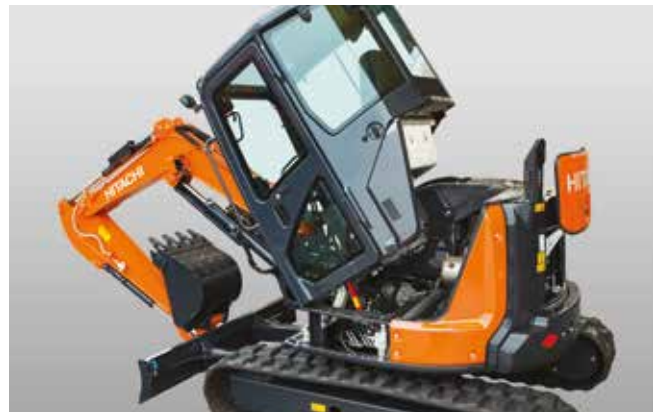
Le plancher inclinable garantit un accès facile au moteur et à la soupape de commande pour un entretien rapide.
