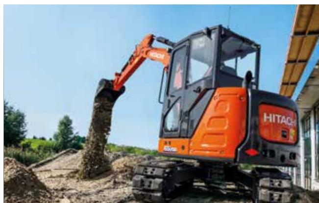
Grâce à son rayon de rotation arrière court, la ZX65USB-6 convient parfaitement aux travaux dans les espaces réduits.
