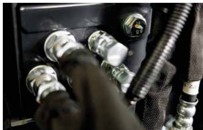
Le raccord rapide (en option) sous la boîte à outils permet une installation ultérieure sécurisée.
