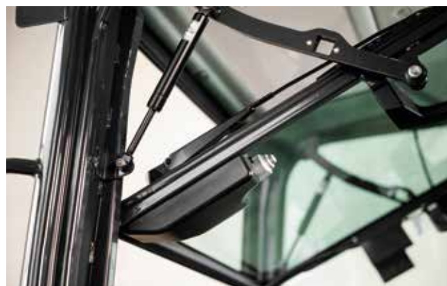
La fenêtre avant s'ouvre facilement et en douceur grâce à l'amortisseur à gaz.
