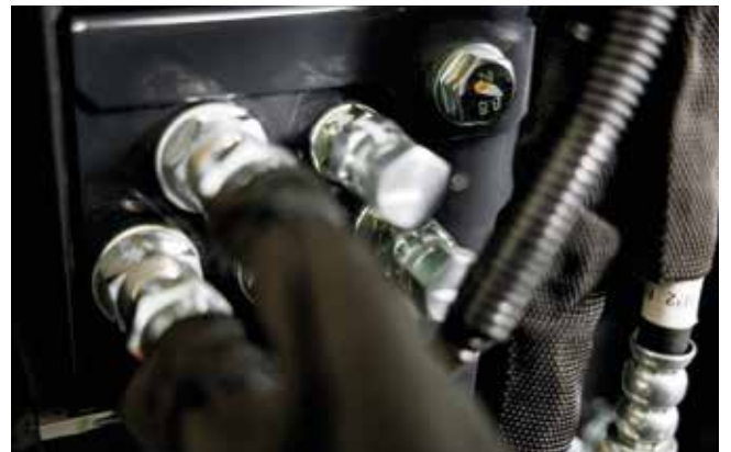
Il collegamento ad attacco rapido (opzionale) posto sotto al vano porta attrezzi, consente l'installazione dei retrofit in condizioni di sicurezza.
