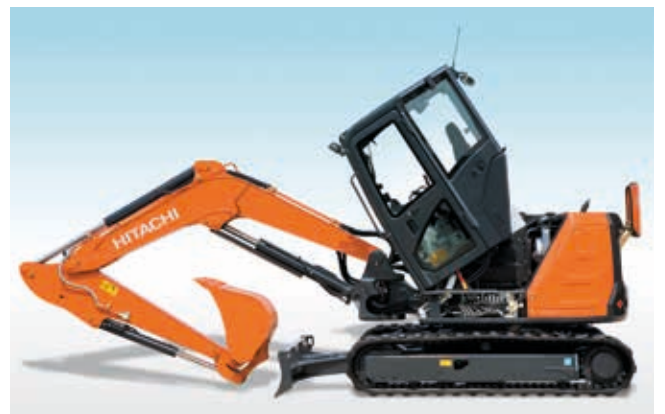
Die kippbare Kabine ermöglicht einen einfachen Zugang zum Motor und zum Steuerventil für eine schnelle Wartung.
