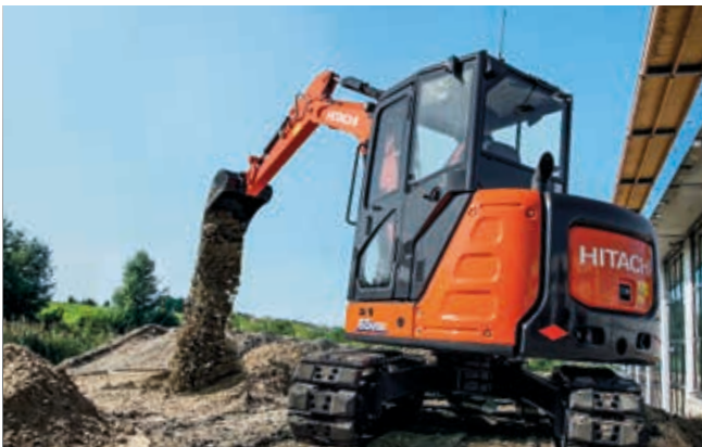
Dank des kleinen Heckschwenkradius ist der ZX65USB-6 ideal für Arbeit auf engem Raum.
