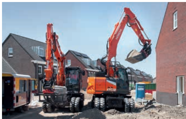
Lo ZX135W-7 può ruotare entro un raggio di 3,5 metri (1.740 mm posteriore e 1.750 mm anteriore).
