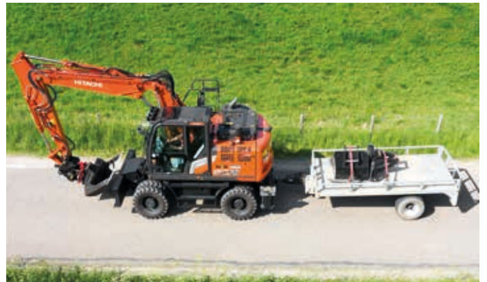
Un ensemble de support de remorque est disponible en option pour plus de commodité et de polyvalence.
