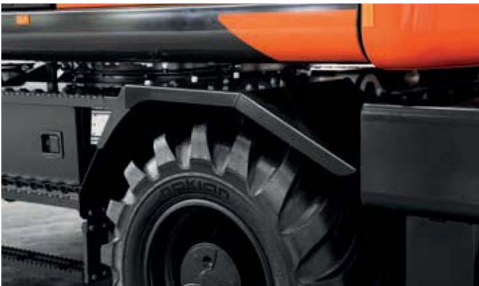
I parafanghi sul sottocarro proteggono la struttura superiore e le luci dallo sporco, mantenendo la macchina pulita.
