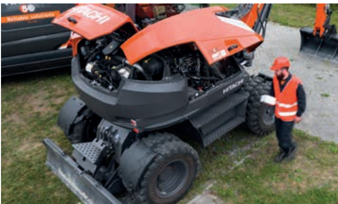
Gut zugängliche Wartungspunkte gewährleisten eine einfache und schnelle Wartung.
