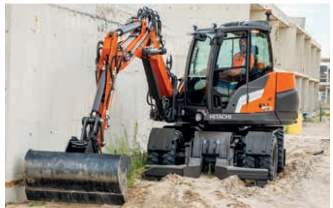
Effizientes Arbeiten auf engstem Raum dank geringem Wenderadius und Schwenkausleger.
