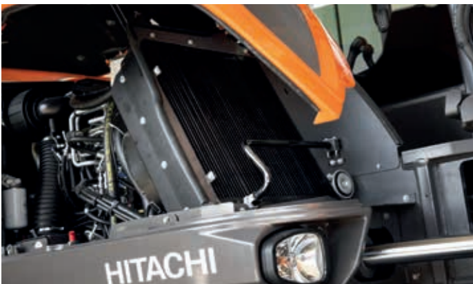
Einfach zu reinigender Kühlraum.
