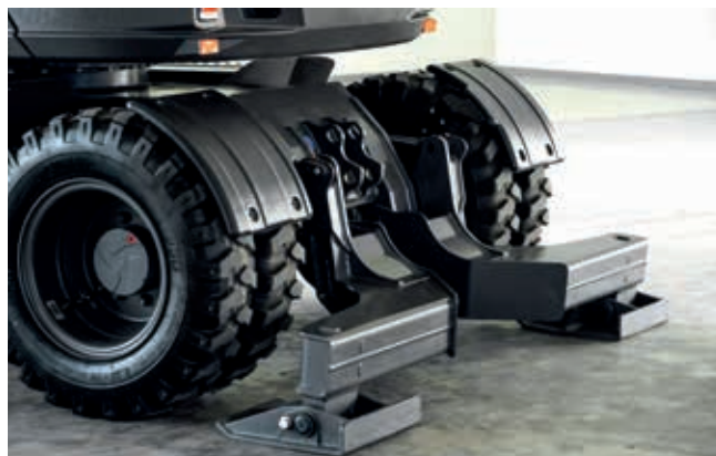
Die unabhängig voneinander bedienbaren Abstützpratzen bieten zusätzliche Stabilität.
