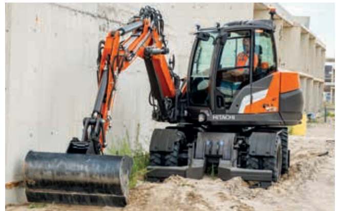
Travaillez de manière efficace dans les espaces restreints grâce au rayon de braquage arrière court et au déport de flèche.
