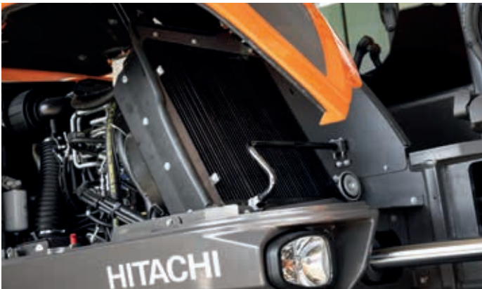
Le compartiment du radiateur est facile à nettoyer.
