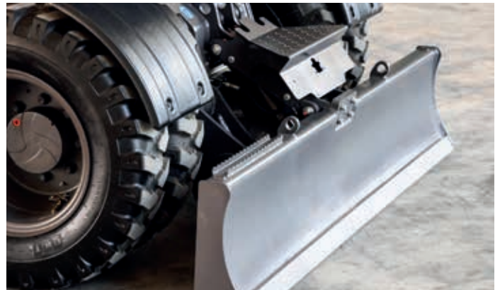
Pour plus de commodité et de polyvalence, la lame est préparée pour être installée sur le crochet de remorquage.
