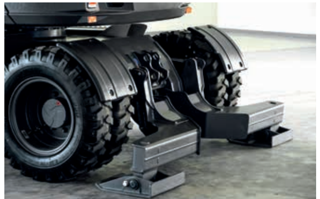
Les stabilisateurs, qui fonctionnent indépendamment, améliorent la stabilité.
