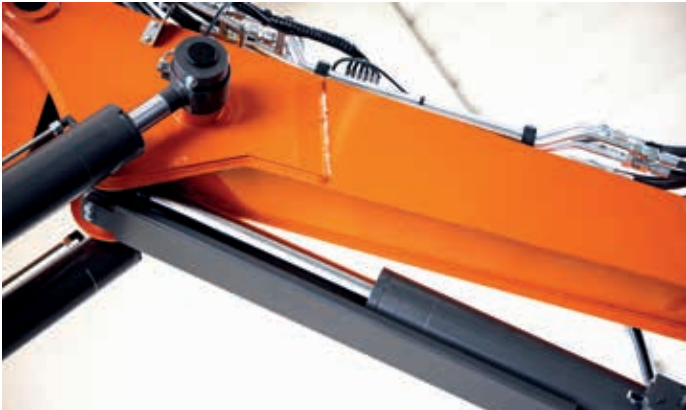
La protection du vérin de flèche améliore la durabilité.
