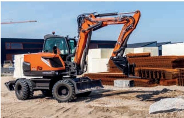
Une manœuvrabilité exceptionnelle grâce aux quatre roues directrices.
