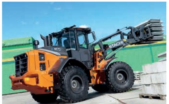
Das Parallelhubgerüst bietet zusätzliche Kontrolle beim Be- und Entladen.
