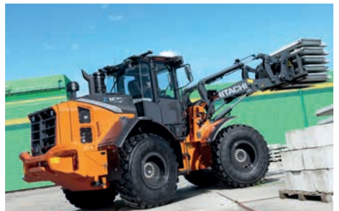
Le bras de levage parallèle améliore le contrôle lors du chargement et du déchargement.
