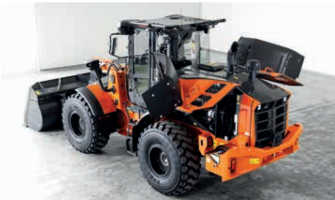
Le capot moteur facilite l'accès pour les inspections quotidiennes.
