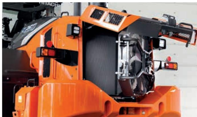
Il sistema di funzionamento intelligente della ventola evita l'intasamento dei radiatori.
