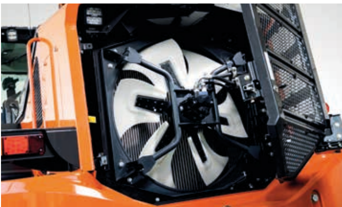
Le système de fonctionnement de ventilation intelligente empêche le colmatage des radiateurs.
