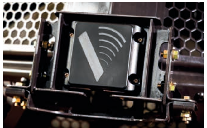
Le système de détection des obstacles à l'arrière améliore la sécurité sur le lieu de travail.
