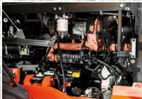
Neuer Stufe IV-Motor reduziert Kraftstoffverbrauch.
