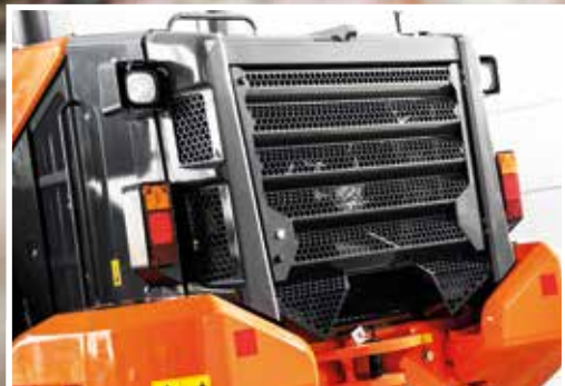
Der neue Heckgrill schützt den Kühlerraum.
