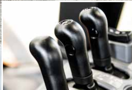
Le commutateur d'augmentation rapide de puissance accroît la puissance lorsque c'est nécessaire.
