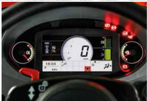
Le moniteur LCD affiche le statut et les paramètres de la machine.
