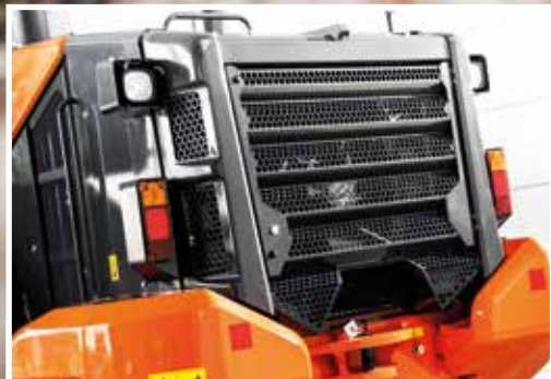
Une nouvelle grille arrière protège le compartiment du radiateur.
