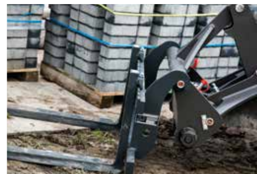
Anbaugeräte lassen sich mithilfe des Schnellwechslers sicher und einfach montieren.
