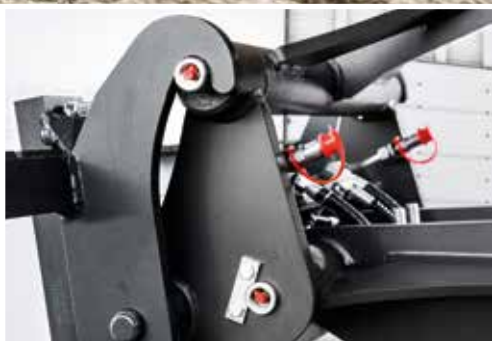
Elektro-hydraulisch betriebener Schnellwechsler für ein einfaches Anschließen von Anbaugeräten.
