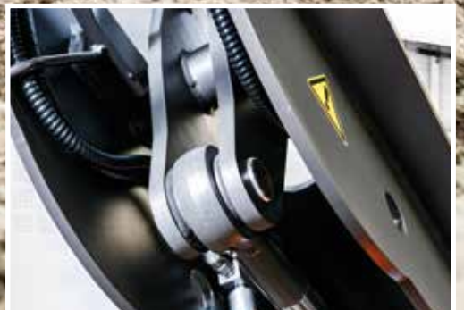
Die Verlegung von Schläuchen und Kabeln im Inneren des Monoblock-Auslegers schützt wichtige Komponenten.
