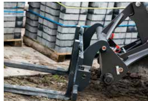
Grazie all'attacco rapido, gli accessori si montano in modo sicuro e semplice.
