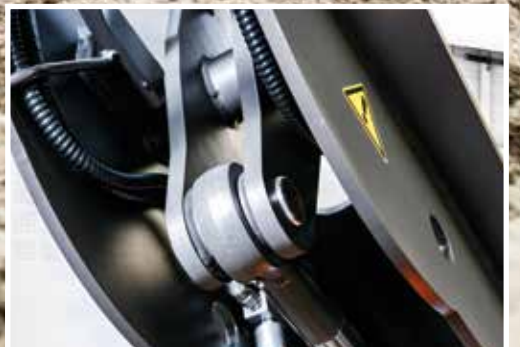
Il posizionamento interno di tubi flessibili e cavi nel braccio di penetrazione protegge i componenti chiave.
