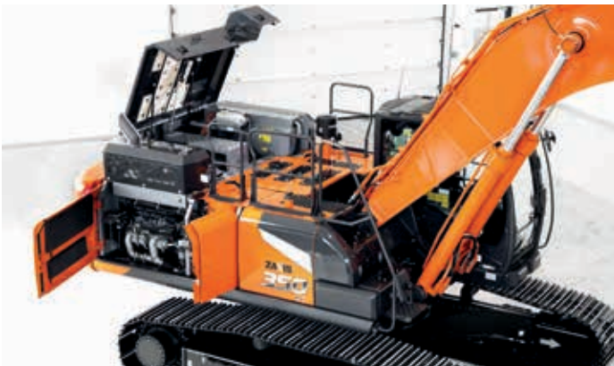
Le capot moteur équipé d'amortisseurs (ZX300 / ZX350) facilite l'accès lors des inspections quotidiennes.
