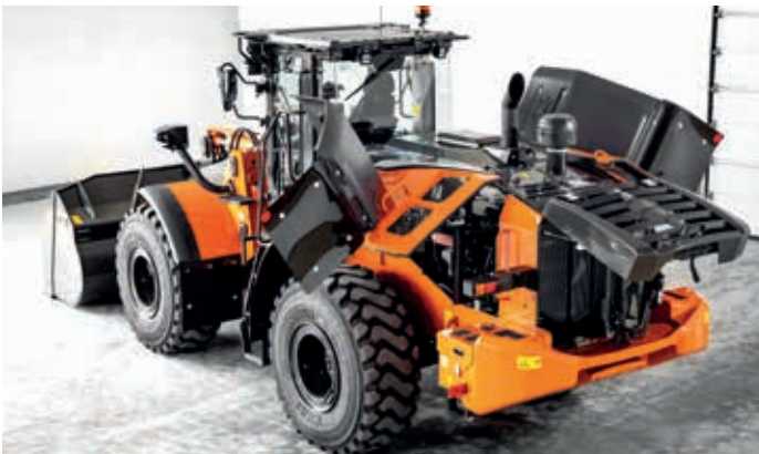
Le capot moteur facilite l'accès aux fins des inspections quotidiennes.
