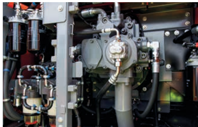
Le système hydraulique HIOS V permet une économie de carburant de jusqu'à 11 %.
