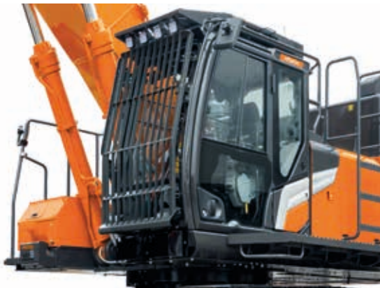
Le modèle ZX530LCH-7 possède, de série, une protection avant, une protection arrière et quatre plafonniers.
